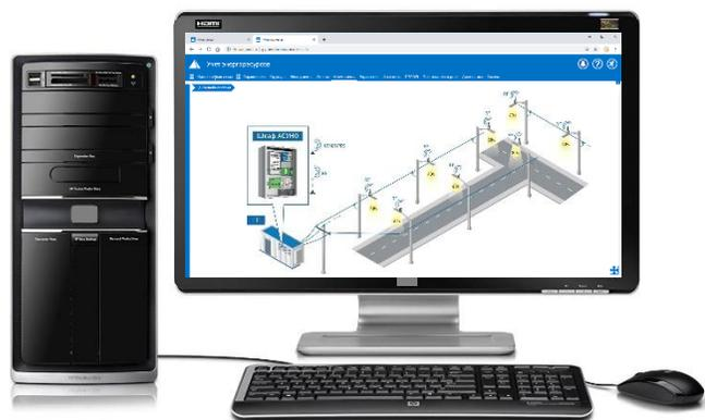
Функция АСУНО – специализированный инструментарий мониторинга и управления наружным освещением в привязке к географической карте.
