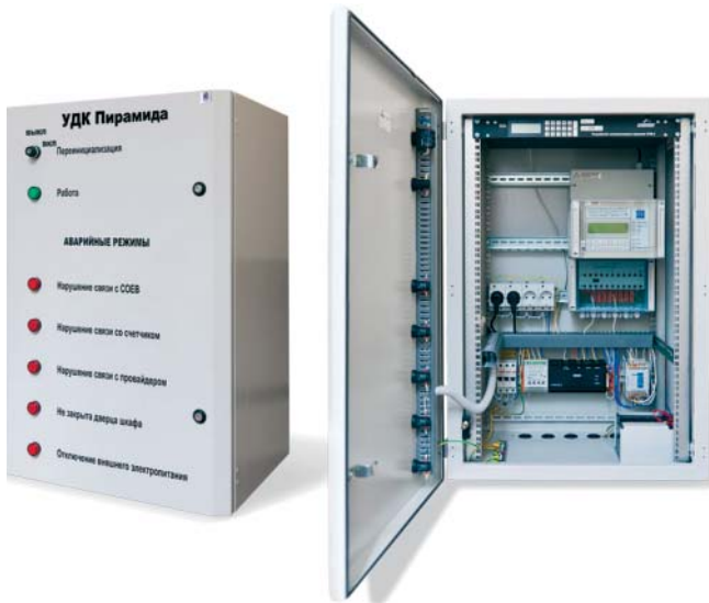
Рис. 4. Устройство дистанционного контроля "УДК-Пирамида"
