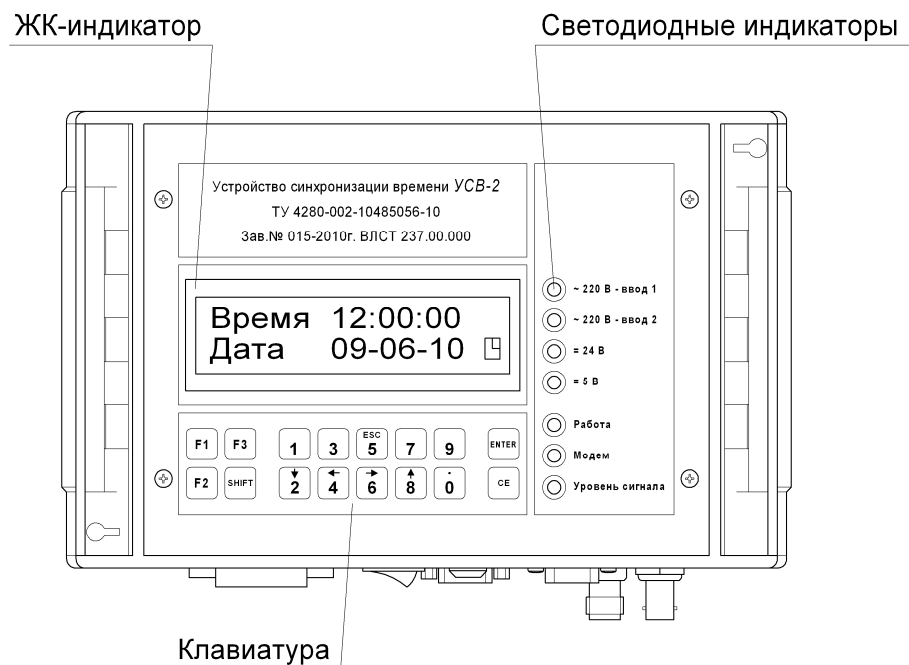
Рисунок 3 – Модификации ВЛСТ 237.00.000-02, ВЛСТ 237.00.000-03, ВЛСТ 237.00.000-05. Вид на лицевую панель.
