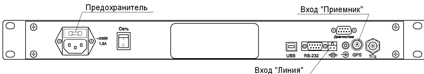
Рисунок 2 – Модификации ВЛСТ 237.00.000, ВЛСТ 237.00.000-01, ВЛСТ 237.00.000-04. В корпусе, высотой 1U. Вид на заднюю панель
