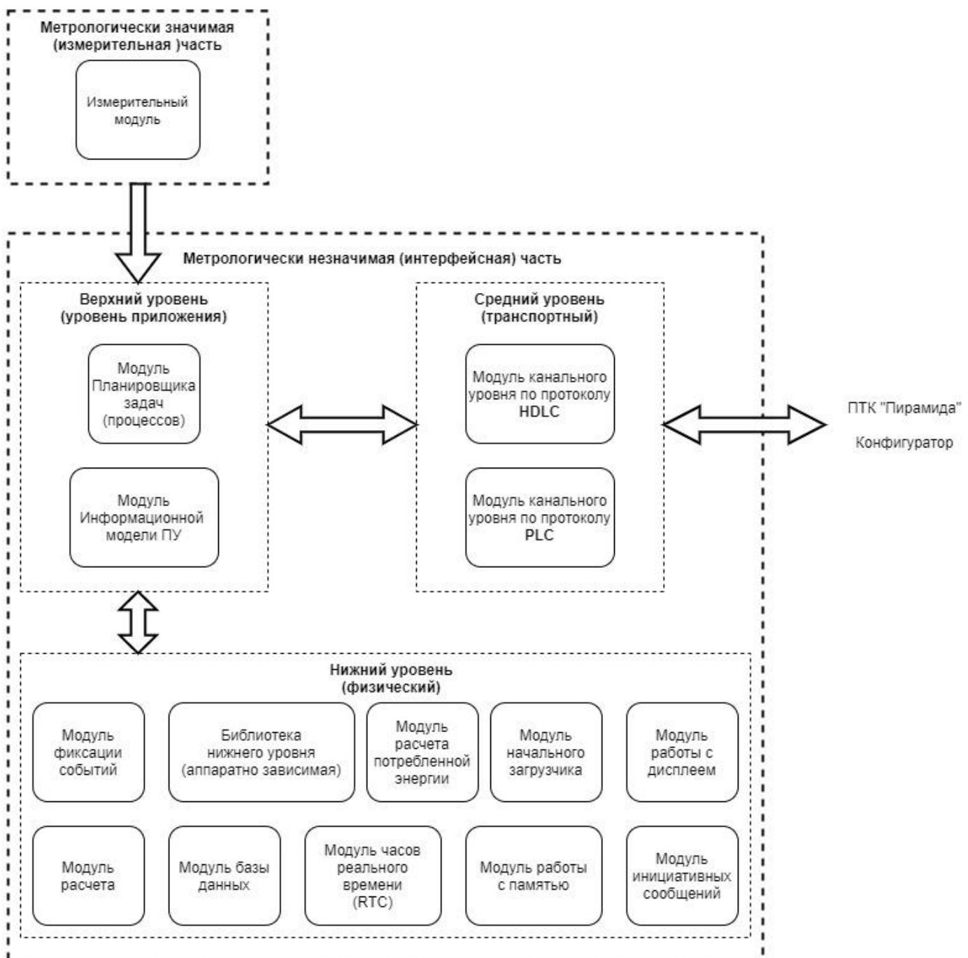
Рис. Д.1. Функциональна схема ВПО
