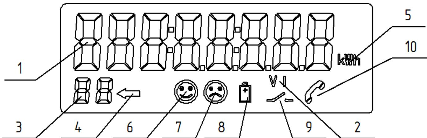
1 – Основная область отображения следующих данных с отображением изменения показаний в реальном времени (размер цифр 9 мм в высоту):
