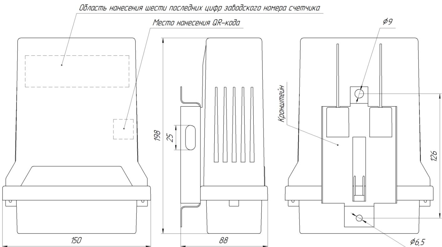
Рисунок А.1 - Размеры счетчика в исполнении С
