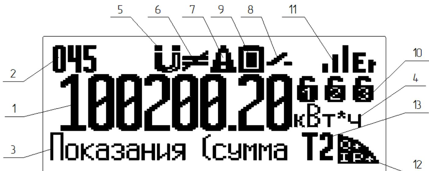
Рисунок 1.1 – Общий вид дисплея счетчика.
