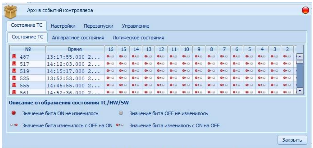
Рис. 8. Вкладка «Состояние ТС » архива событий контроллера.
