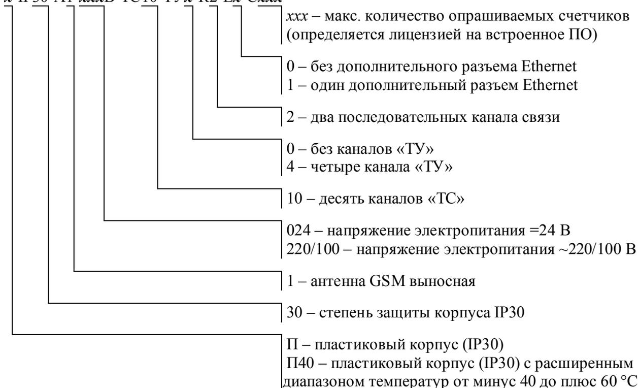
Пример записи модификации контроллера СИКОН ТС65:
